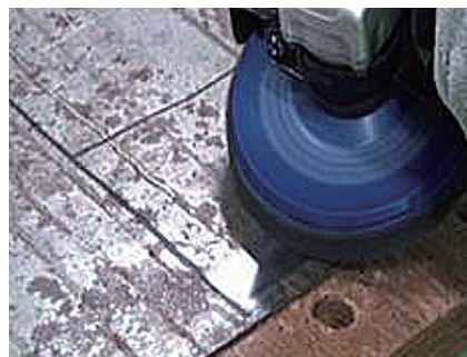
Remover el oxido del metal
